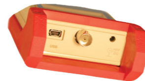
Messsender mit USB-Schnittstelle Signal generator with USB interface
